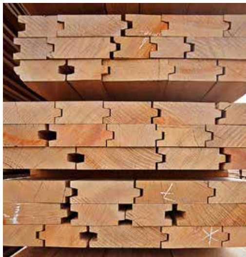
Figuur 3. Vorm en maatverhoudingen van messing en groef: A. rechthoekig (minder gangbaar), B. trapeziumvormig, C. hellingshoek.
