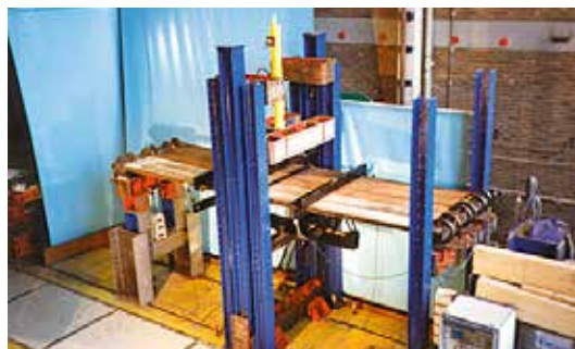
Figuur 7. Proefopstelling om de samenwerkingsfactor van azobé damwandplanken vast te stellen.
